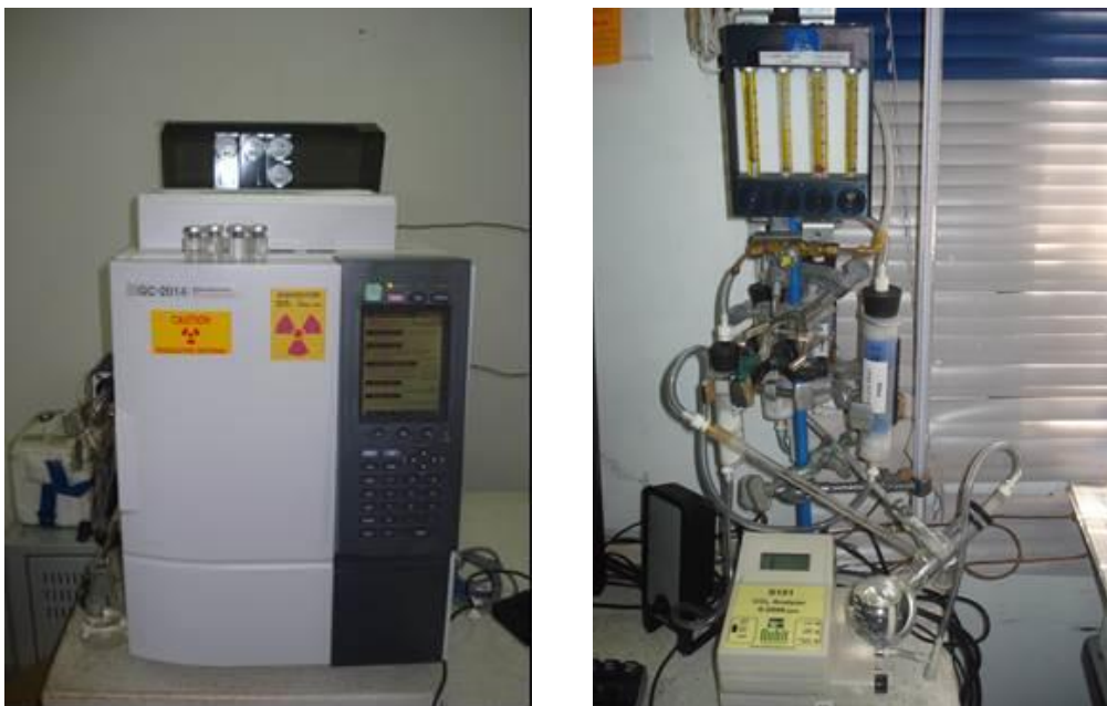
Figura 5. Sistema cromatográfico (Shimadzu®) y de espectrometría infrarroja (Qubit®) usado para la determinación de \text{CH}_4 , \text{N}_2\text{O} y \text{CO}_2 .
